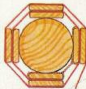
4. Plan en coupe de l'ensouple arrière avec les fils de chaîne qui l'entourent. Les lattes de tension seront introduites entre le rouleau et les fils pour que les couches de fils soient séparées et que la chaîne non enroulée ne soit pas abîmée par le rouleau.
