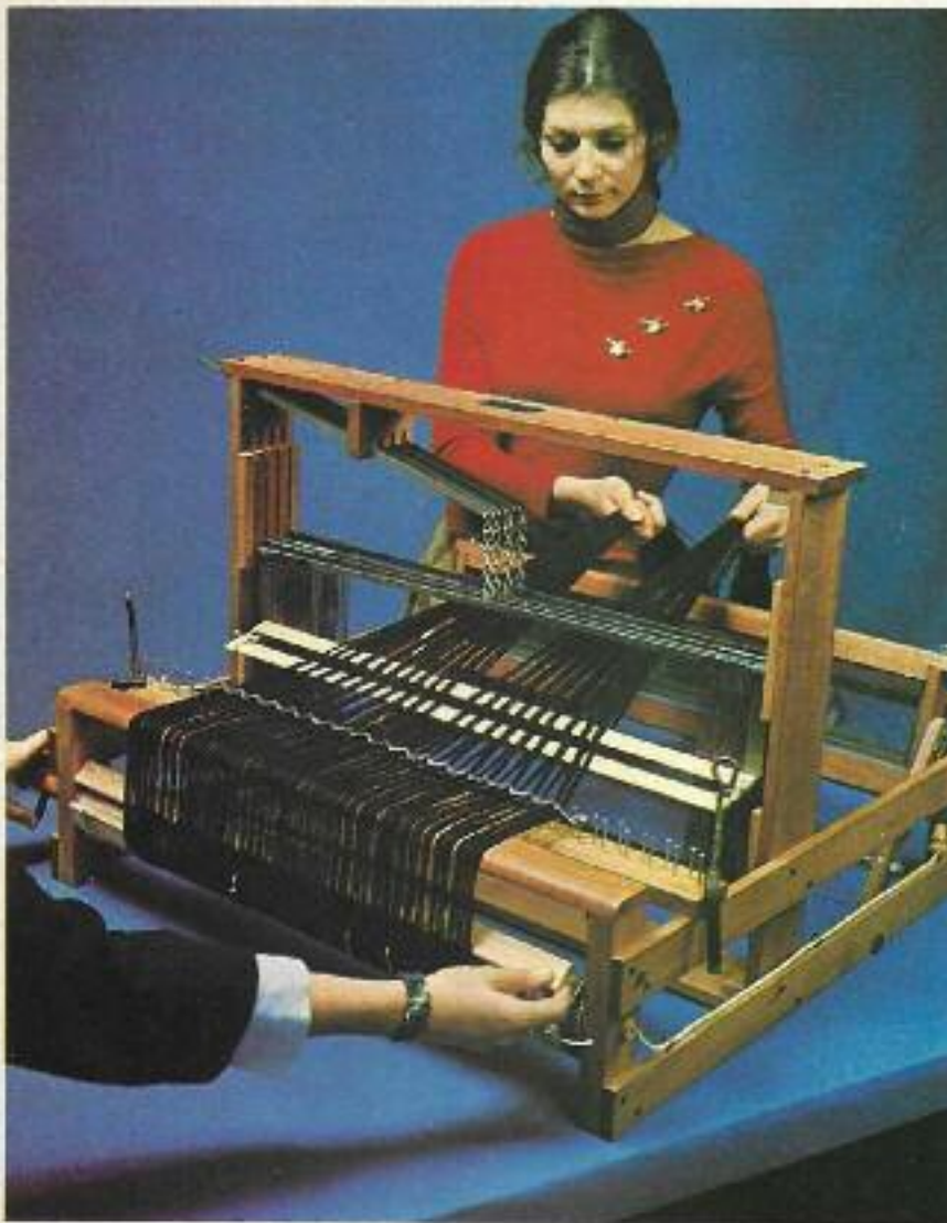
La chaîne s'enroule sur le métier. Une personne fait ce travail tandis que l'autre maintient la tension de la chaîne et empêche que les fils ne s'embrouillent.
