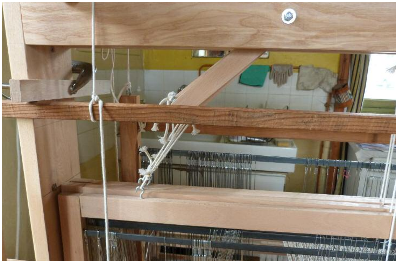
Position cadre 5 levé. La barre reste sous les chutes, tenues par le serre-joint.
